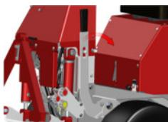
Abb. 11 - Handbremse
