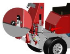
Abb. 15 - Drehzahlregulierung
