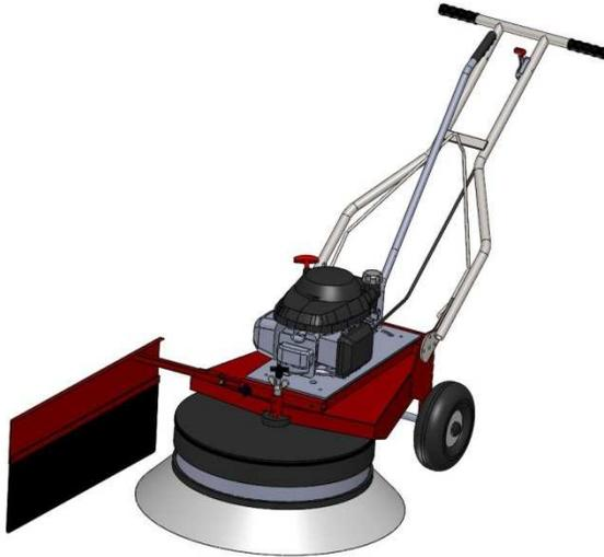
Das Schwadblech wird seitlich am Rahmen des Radialbesens montiert. Dazu wird der schwarze Blindstopfen entfernt und das Gestänge des Schwadblechs in den Rahmen geschoben. Das Schwadblech wird über eine Flügelmutter und einen Kreuzgriff fixiert.
