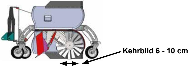
Ist keine ausreichende Breite mehr vorhanden, oder ist der Bodenandruck zu gering, muss die Aufhängung der Kehrwalze nachgestellt werden.
