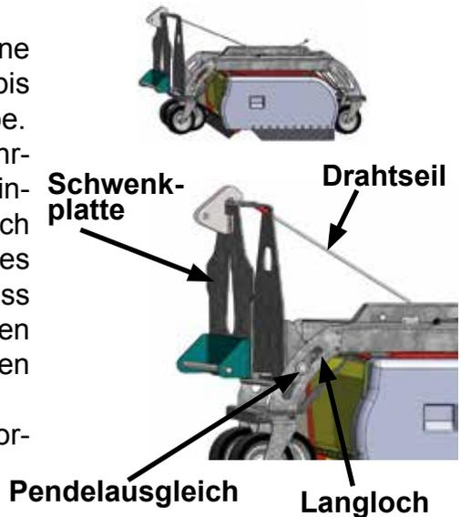
Durch die Betätigung des entsprechenden Steuerventils die Kehrwalze einschalten und mit dem Kehrvorgang beginnen.
