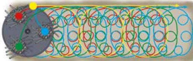
(Abb. 4 - Fegeprinzip WKB)
