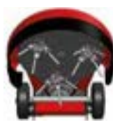
(Abb. 18 - Drahtzöpfe wechseln)
