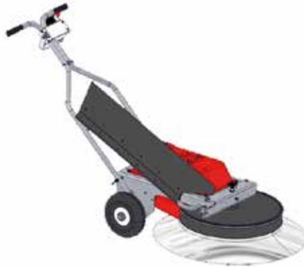
(Abb. 20 - Schwadblech einschieben)
